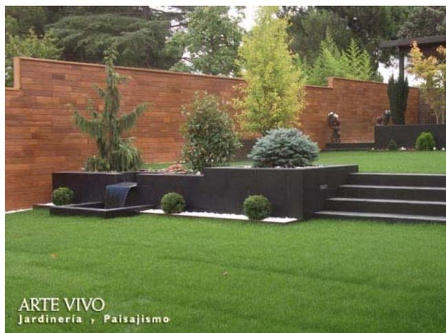
Jardinería con estanque de obra integrado anexa a escaleras, todos revestidos de Gres porcelánico color negro, en jardín con cerramiento lateral de madera de lapacho sobre rastreles, gravillas y césped en tepes delimitados con fleje metálico en Urbanización Montepíncipe de Boadilla del Monte.
