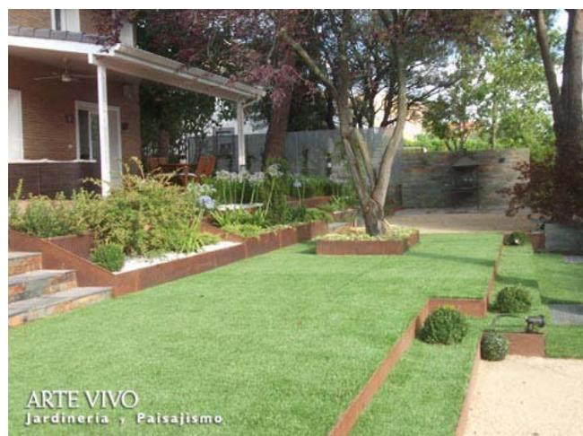
Pavimentos de jabre y césped artificial a distintos niveles en jardín con peldañado y plantaciones en bancales formados con chapa de Acero corten en Pozuelo de Alarcón.
