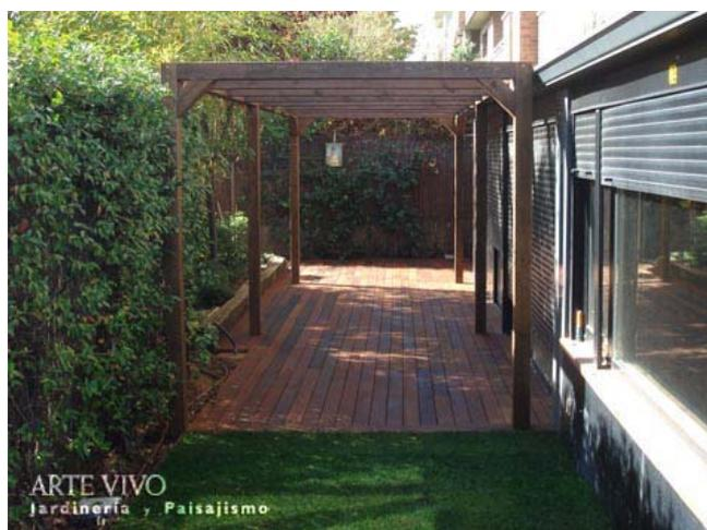
Pérgola de Madera laminada con travesaños superiores, 6 pilares de sección y vigas de carga afianzadas con jabalcones en jardín con tarima de Madera tropical y césped en tepes de Soto de la Moraleja, Alcobendas.
