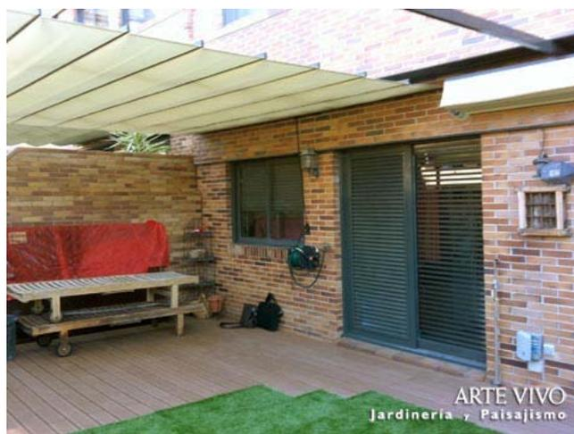
Doble toldo superior de lona acrílica en pérgola con perfilera metálica en jardín con tarima de madera técnica sobre solera y césped artificial en Las Rozas de Madrid.
