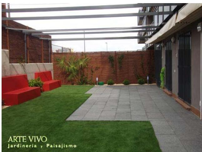
Césped sintético y pavimento de piedra regular de basalto, con plantación perimetral sobre gravilla en jardín particular con cerramientos de mimbre horizontal, pérgola metálica adosada con tres toldos superiores y bancos de obra enfoscados y pintados de Tres Cantos.
